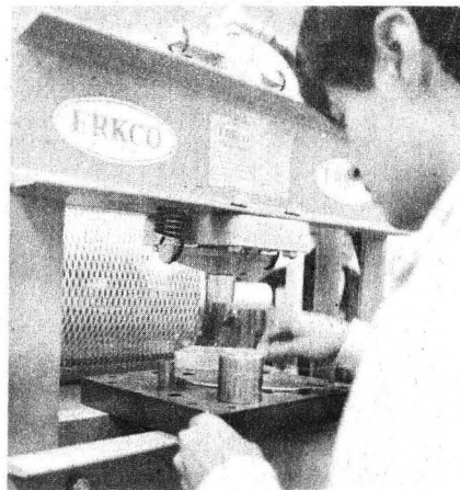
Prensa hidráulica para producir pastillas superconductoras.
