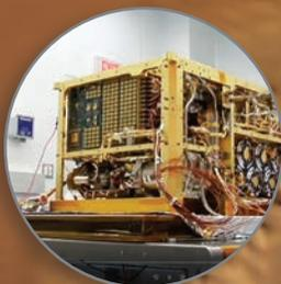
*Curiosity* ha colectado rocas desde la base del cráter Gale; pulveriza e introduce su polvo en los hornos del instrumento SAM, donde se calientan y se liberan los gases de los componentes que están en las rocas.
