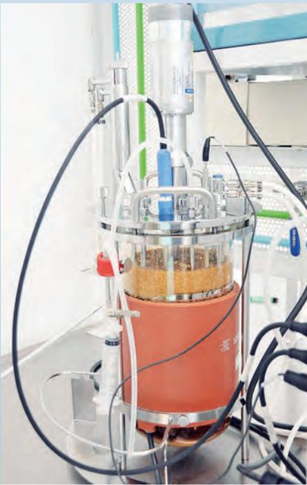
• Reactores para generar hidrógeno y biobutanol.
