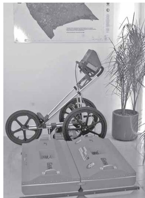
Radar de penetración terrestre.
