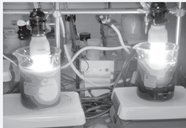
La reacción inicia al recibir la radiación de las lámparas.
