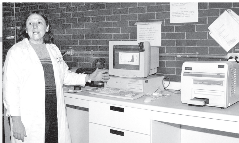
Dosímetro termoluminiscente y equipo lector.
