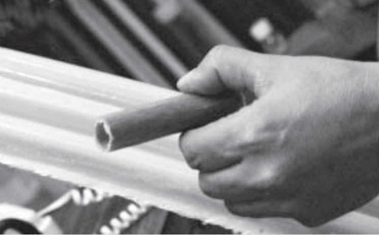
Tubo de nanocompuestos con PET y arcilla.
