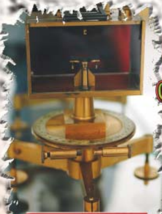
Balanza Magnética Carpentier Para medición de campos magnéticos vertical (Observatorio de Física de la UNAM)
