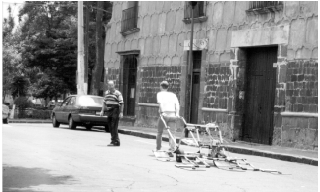
Equipo utilizado para realizar el estudio electrostático de la zona. Aquí los antropólogos efectúan el análisis en la calle de Higuera, en Coyoacán.
